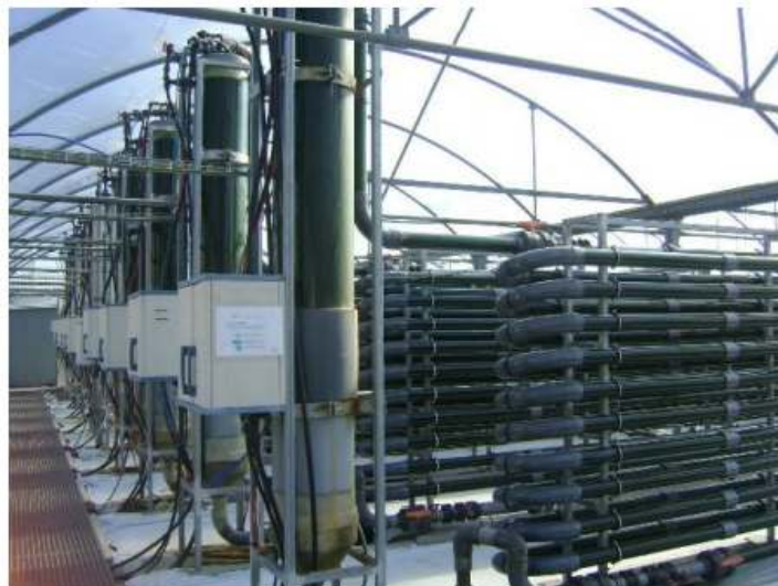
Fotobiorreator tubular tipo serpentina. CAJAMAR. Universidade de Almería - Espanha.
