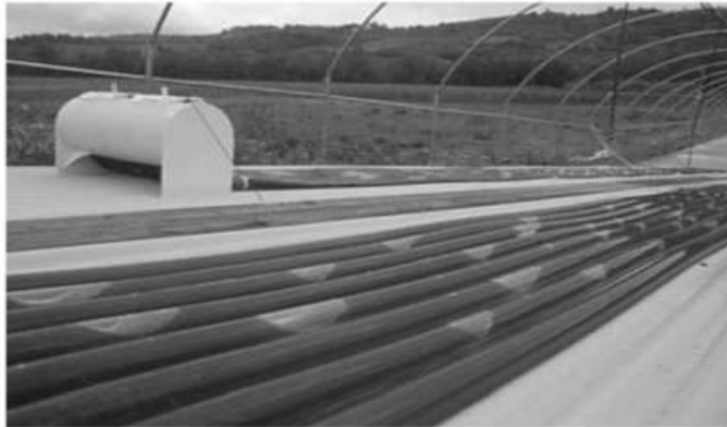
Exemplo de fotobiorreator tubular tipo manifold .
