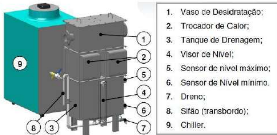
Figura 46: Vaso de desidratação com trocador de calor de placas
