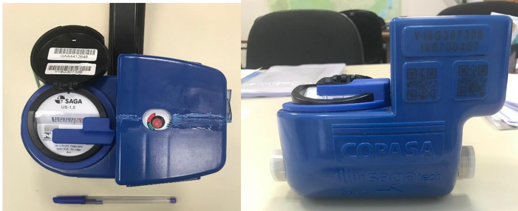
Figura 3: Hidrômetro Controlador de Volume (HCV)
